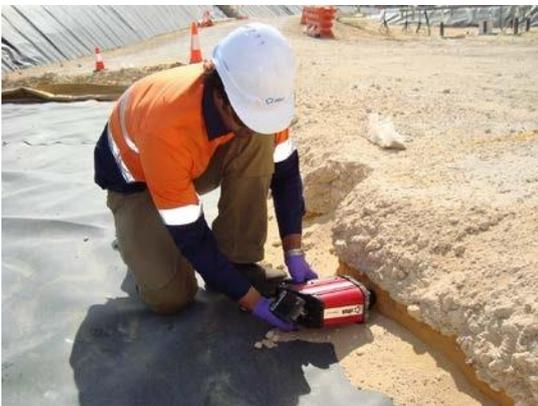
RemScan est utilisé pour surveiller le sol après l'assainissement afin de s'assurer qu'il est conforme aux exigences du site. Pour les processus de bioremédiation, RemScan peut surveiller la diminution de la concentration de la contamination au fil du temps pour déterminer le point final. Une fois que le sol est « propre », il peut être retiré de le tampon de bioremédiation, augmentant ainsi l'utilisation et le débit de l'installation de bioremédiation.
