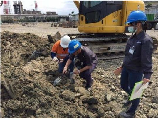
RemScan est utilisé pour trier les sols propres des sols contaminés, minimisant ainsi la quantité de sol à assainir.
