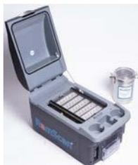
RemScan fournit une erreur d'avertissement si les échantillons ont une teneur en humidité libre supérieure à 5 %, si les échantillons de sol humide peuvent être séchés à l'air ou séchés à l'aide de l'unité de séchage portable.
