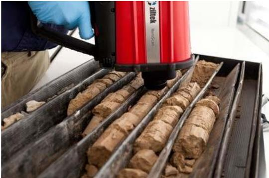
RemScan est utilisé pour mesurer la concentration d'hydrocarbures à la surface du sol permettant à l'utilisateur de délimiter rapidement la zone contaminée. Les profils de profondeur peuvent être mesurés en prenant une carotte de forage, en posant la carotte et en utilisant RemScan pour mesurer directement la concentration d'hydrocarbures en différents points (profondeurs) le long du noyau.
