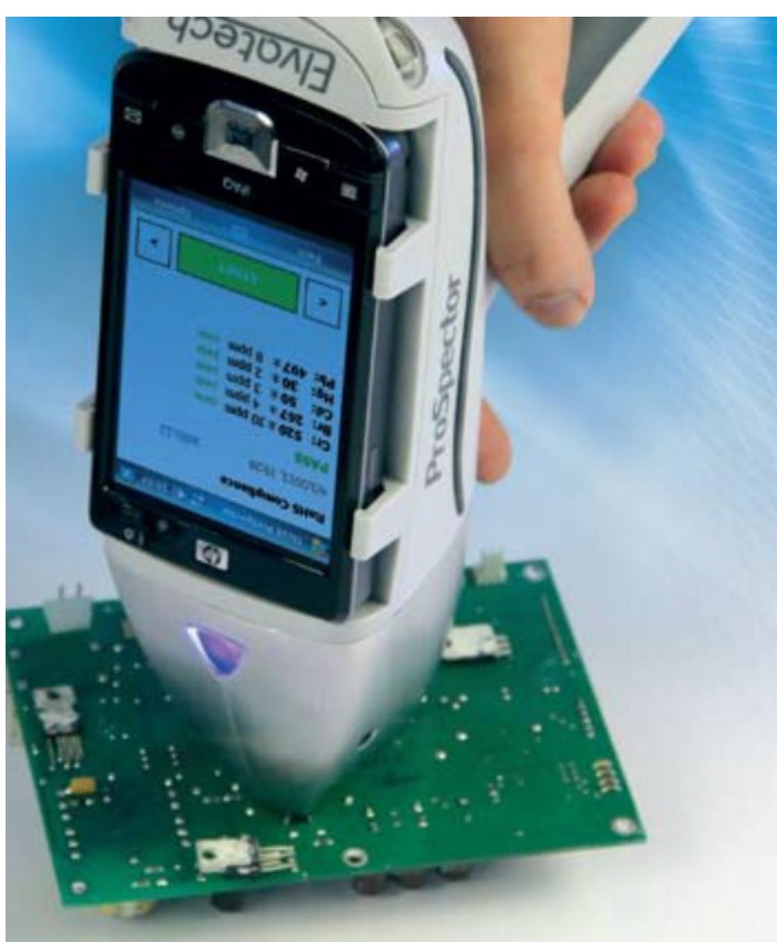
CONTRÔLE DES SOUDURES PLOMB
